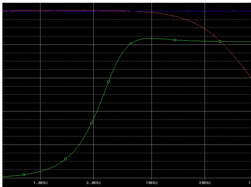
Figur 5. AC-sweep av delningsfilter.
